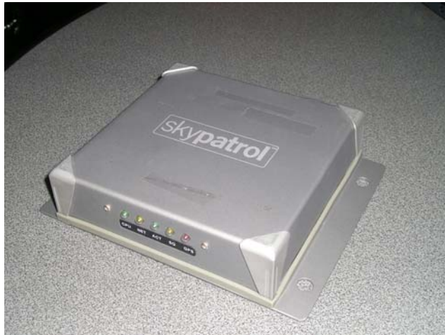
Fig. 3.11 Equipo Skypatrol utilizado por el proveedor del servicio de rastreo
