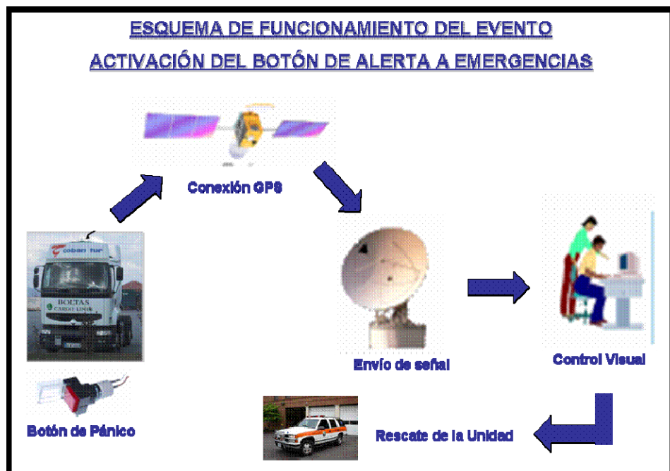
Fig. 3.12 Esquema de Funcionamiento: Botón de Alerta a Emergencias
