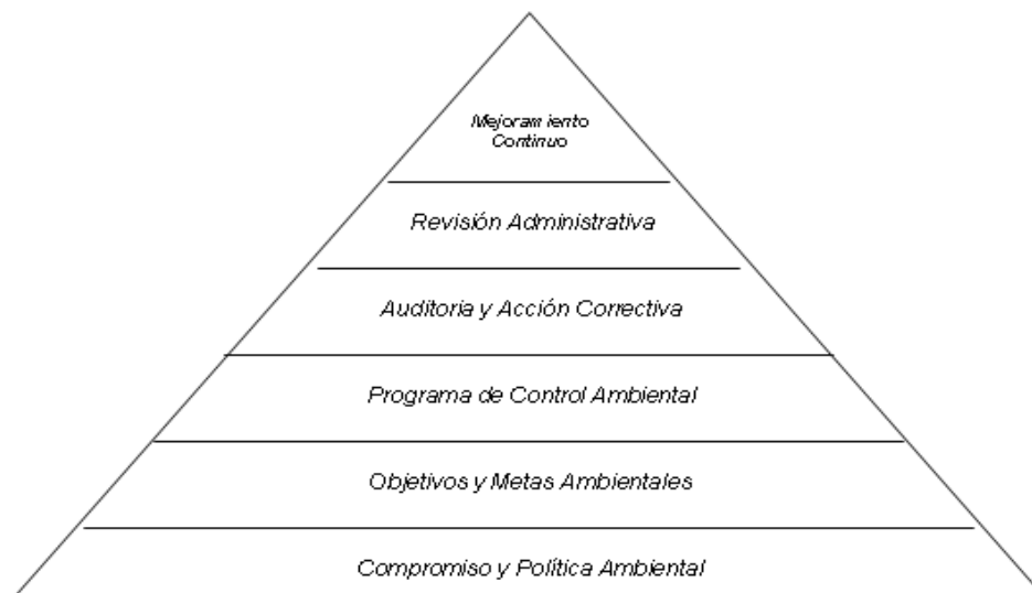
Fig. 2.2. Elementos Básicos de un SGA ISO 14001.
