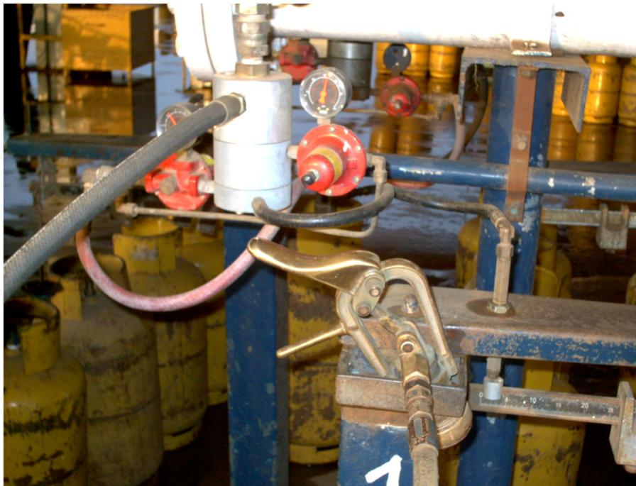
**FIGURA 2.5** DISPOSITIVO CORTE DE FLUJO DE GLP NEUMÁTICO
