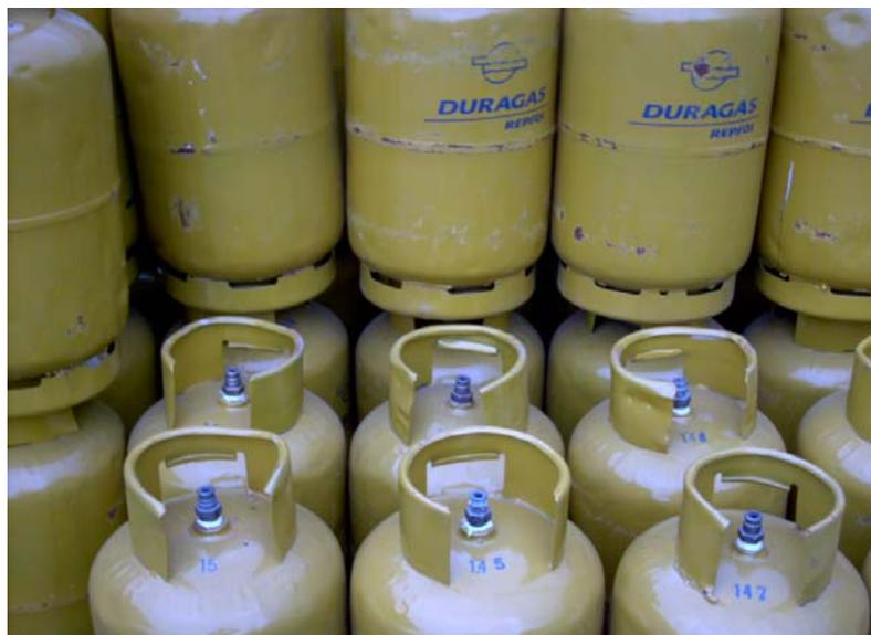
FIGURA 2.3 ILUSTRACIÓN DE LA TARA ROTULADA EN CILINDRO
