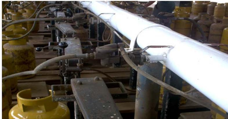
**FIGURA 1.4** DISPOSITIVO PARA CORTE DE FLUJO DE GLP
