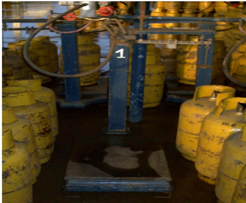
**FIGURA 1.5** BALANZA MECÁNICA PARA LLENADO DE CILINDROS
