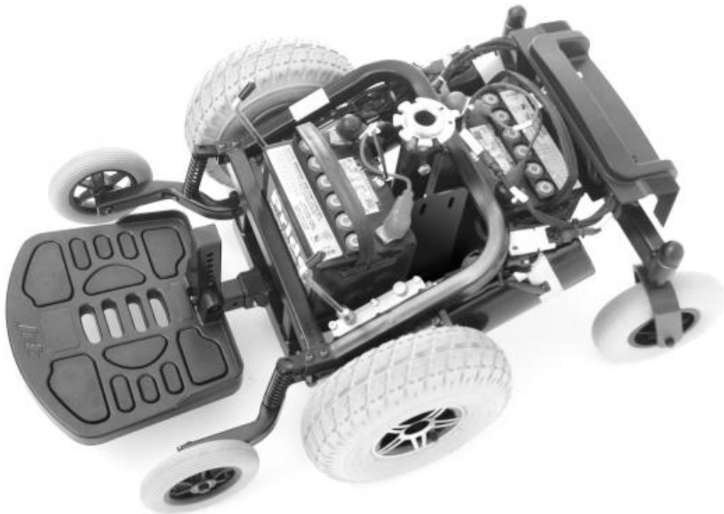
Figura B-4. Base Mecánica del Jet 3 (guardera de carrocería removida)
