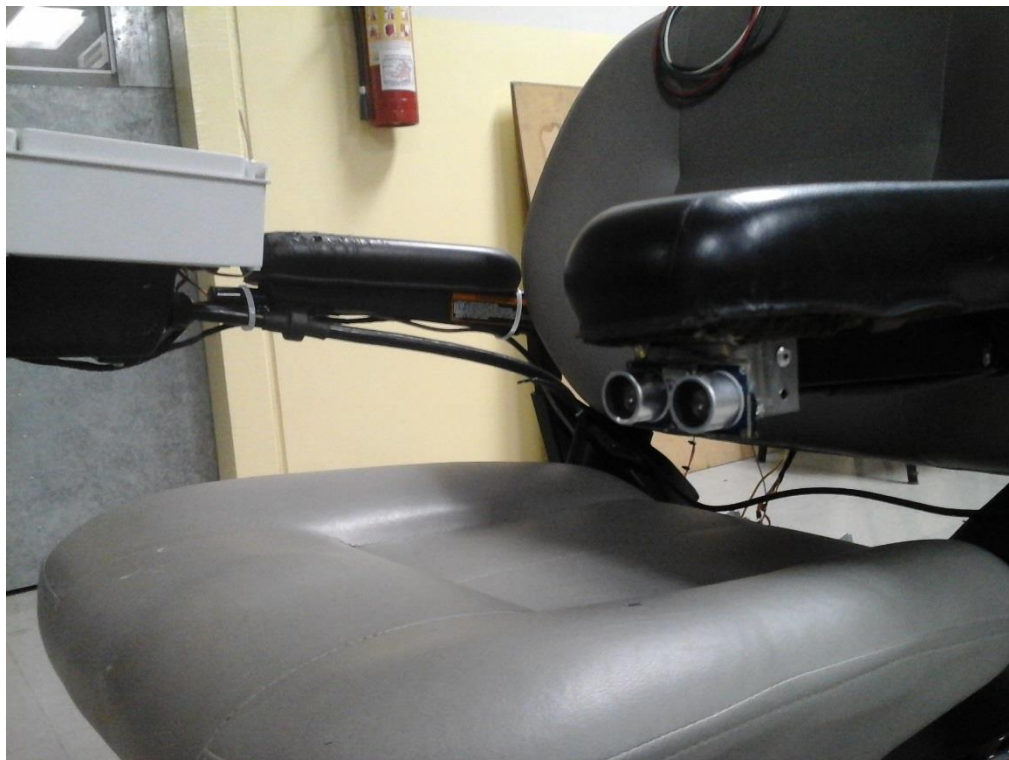
Figura 3-17. Sensor ultrasónico frontal bajo el apoyabrazo izquierdo
