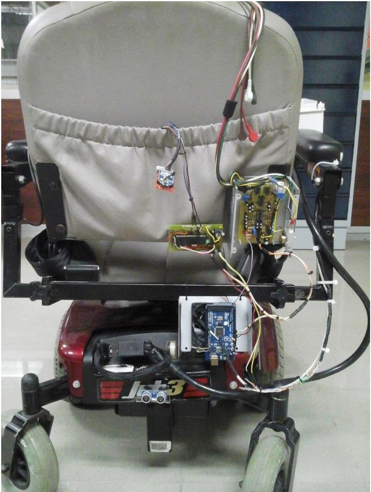
Figura 3-11. Vista posterior de la silla con el nuevo sistema de control instalado en fase de pruebas
