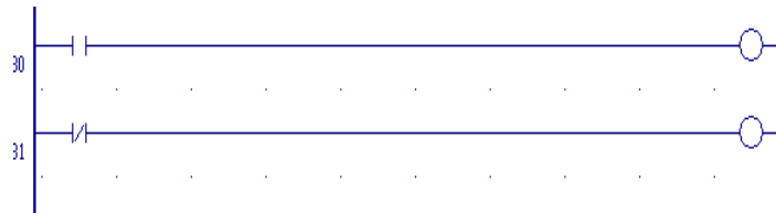
Figura 5.11. Contactos Normalmente abiertos/cerrados
