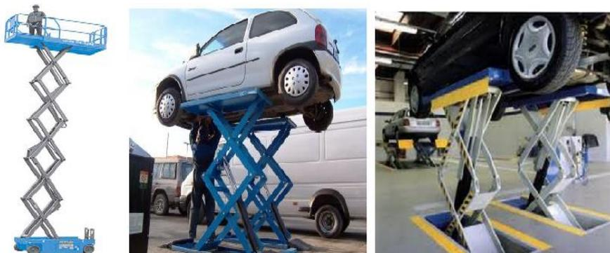
**Figura 1-1.** Ejemplos de elevadores hidráulicos tipo tijera.
