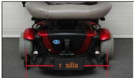
**Figura 2.30. Separación de las ruedas de la silla**
