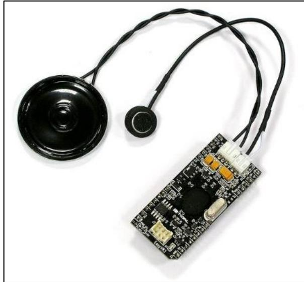
**Figura 1.6. Tarjeta EasyVR con micrófono y altavoz**
