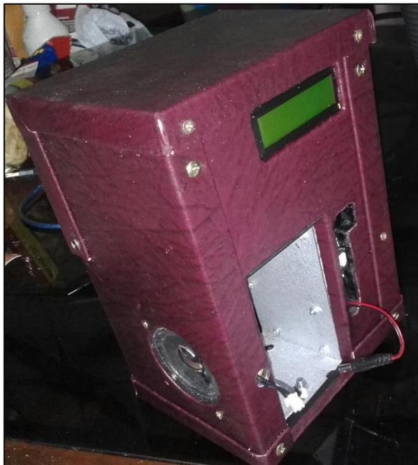
**Figura 3.1. Sistema de reconocimiento de voz que se acopla a joystick controlador.**
