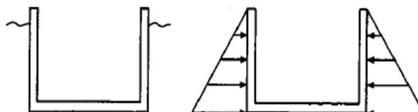
Figura 10: Esquema de tanque bajo condición de empuje vertical de relleno de suelo
