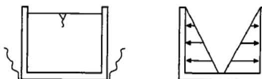
*Figura 9: Esquema de tanque sometido a presión hidrostática*
