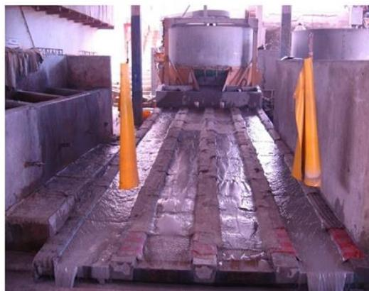
**Figura 2. 3:** Molino Chileno utilizado para la extracción de oro en las Minas
