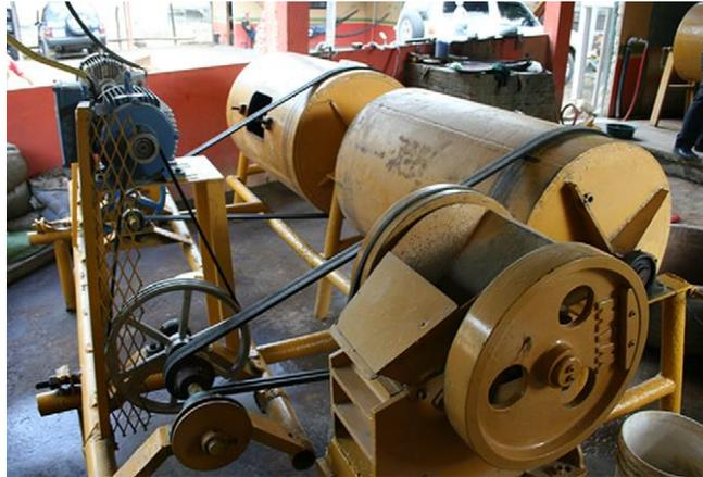
**Figura 2. 4:** Maquina de Chanchas utilizado para la extracción de oro en las Minas
