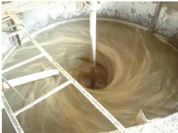
**Figura 2. 5:** Tanque de Cianuración
