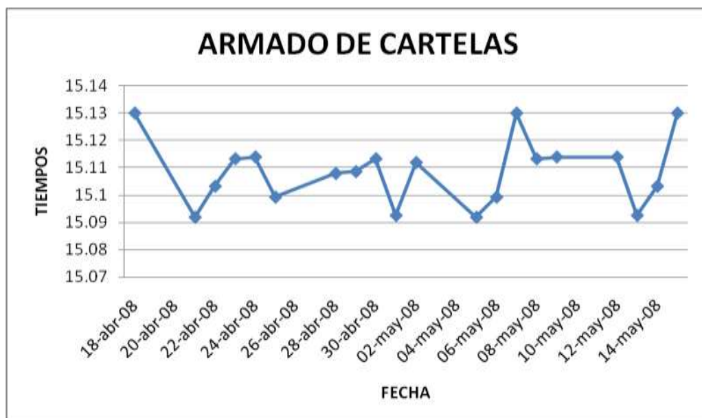
Figura 4.31 Gráfico de control del proceso armado cartelas Realizado por: Carmen Helguero Fuente: A&H Construcciones Metalmecánicas
