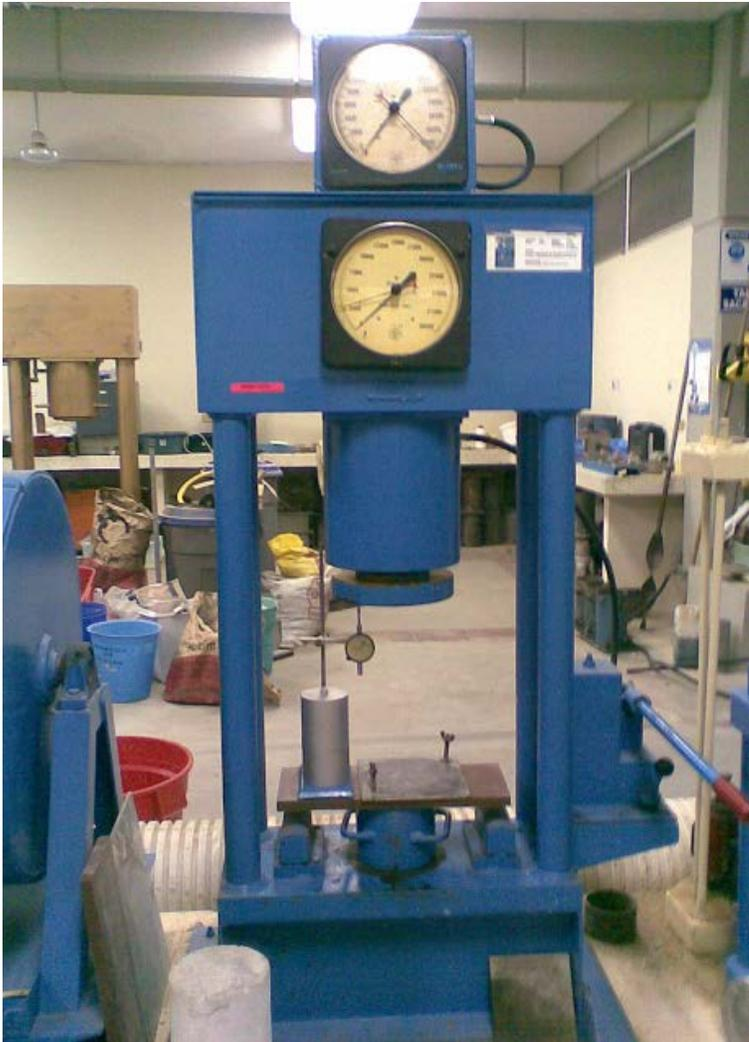
**MAQUINA PARA ENSAYOS DE COMPRESION**
