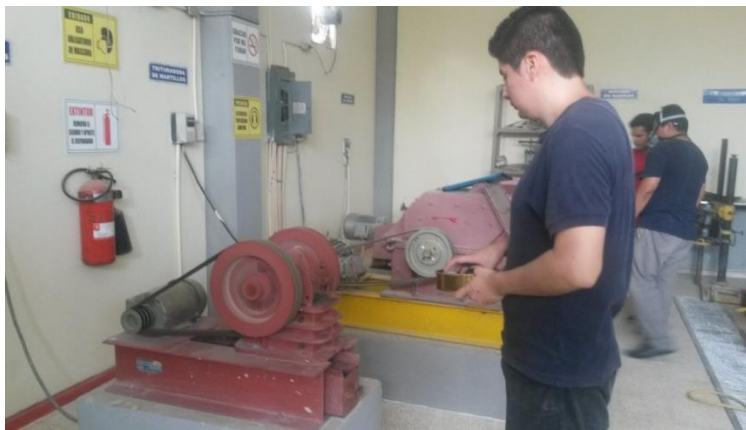
Figura 4.3. Preparación de muestras en trituradora de mandíbulas Fuente: Mariño, D. (2015)
