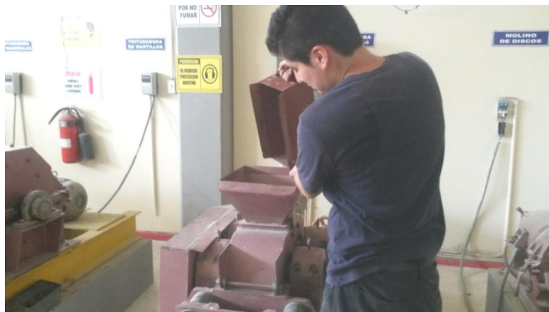
Figura 4.4. Preparación de muestras en trituradora de rodillos Fuente: Mariño, D. (2015)
