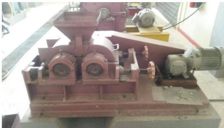
Figura 4.7. Trituradora de rodillos FICT - ESPOL Fuente: Mariño, D. (2015)
