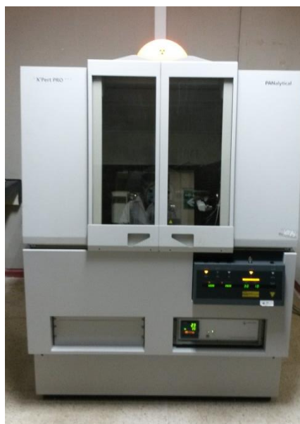
Figura 4.12. Difractómetro de rayos X Fuente: Mariño, D. (2015)
