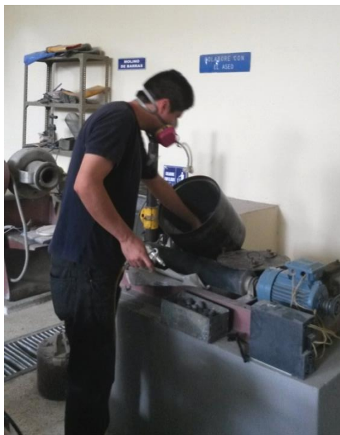
Figura 4.5. Preparación de muestras en molino de bolas Fuente: Mariño, D. (2015)
