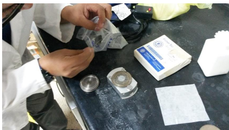
Figura 4.11. Colocación de muestra en portaobjeto DRX Fuente: Mariño, D. (2015)
