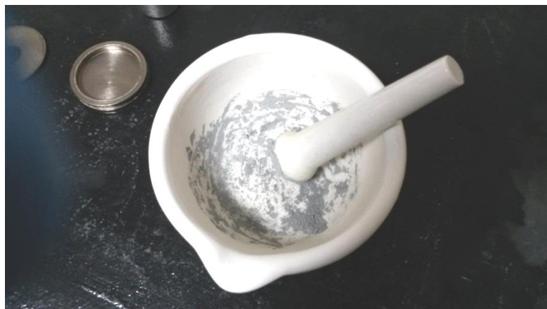
Figura 4.10. Homogenización de muestra Fuente: Mariño, D. (2015)
