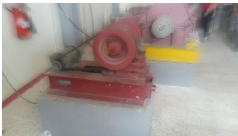
Figura 4.6. Trituradora de Mandíbulas FICT - ESPOL Fuente: Mariño, D. (2015)
