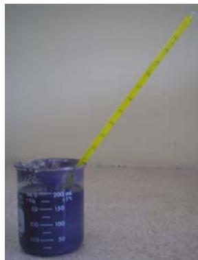
**Figura 3.21 Toma de temperatura del FMR con termómetro.**
