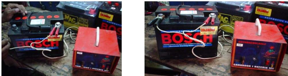
**Figura 4.16** Proceso de recargada de Batería.
