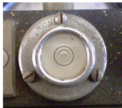
**Figura 3.17** Visor de nivelación del Viscosímetro.
