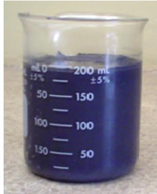
**Figura 3.5 Fluido Magnetorreológico resultante.**
