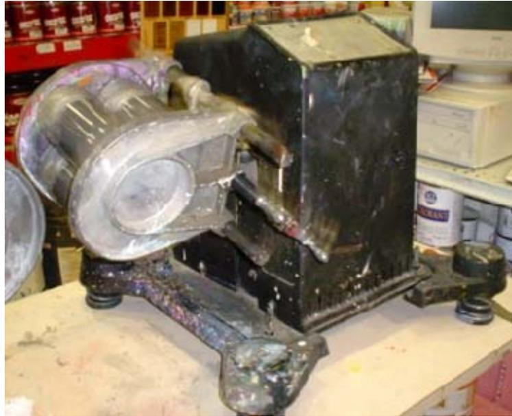
**Figura 3.4 FMR agitándose en una mezcladora de pintura.**
