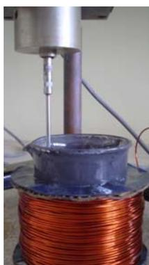
**Figura 3.24 Colocación del spindle dentro del FMR.**
