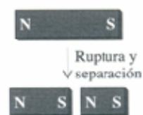
**Figura 1.3 Ruptura y separación de un imán de barra. [5]**
