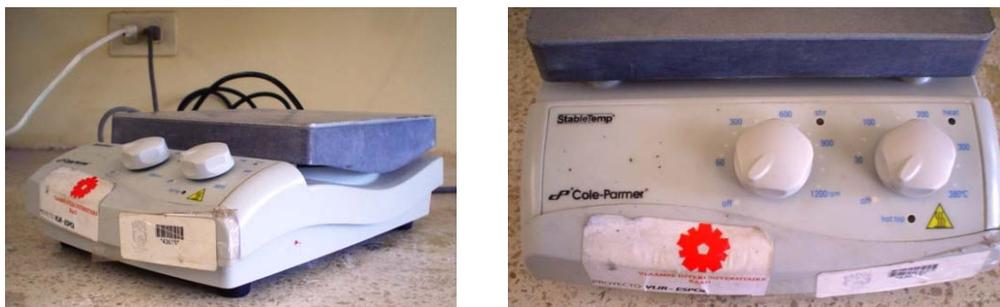
**Figura 3.15 Agitador Magnético – Calentador.**
