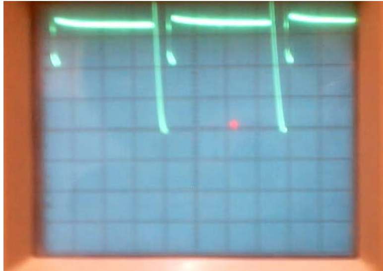
Fig.4.33 Curva Experimental de Voltaje en la Carga. Ciclo de Trabajo 90%
