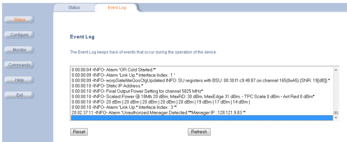
Figura 5.3 Alarma “Cold Started” y configuración de la radio del dispensario de la Maternidad
