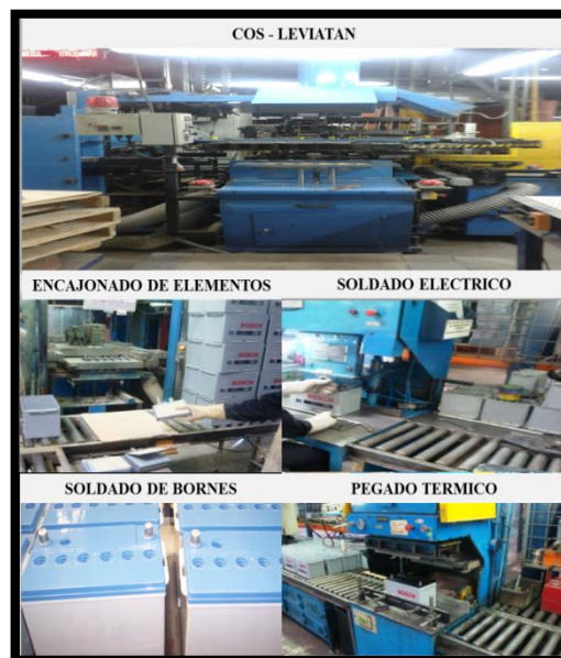
Ilustración 10: Montaje de Baterías
