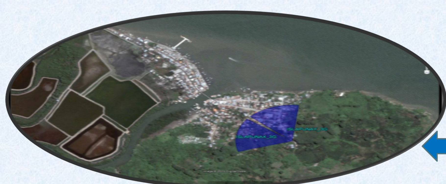
Distribución de los Nuevos Sectores de los Sistemas Radiantes simulando el diseño propuesto para la migración a Tecnología UMTS-3G en la Isla Puná.
