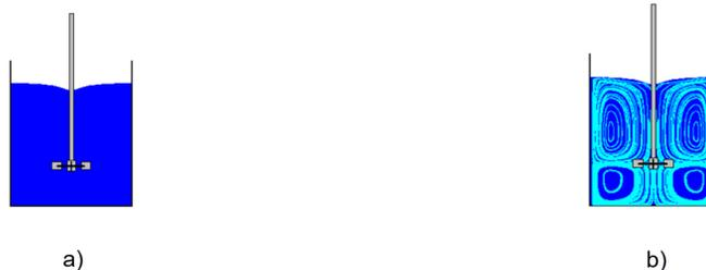
**Figura C-2. Flujo en a) Estado inicial; b) 5 segundos del inicio de la mezcla.**
