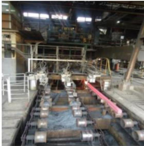
Foto 2. Máquina de colada continua a ser reemplazada aun en operación
