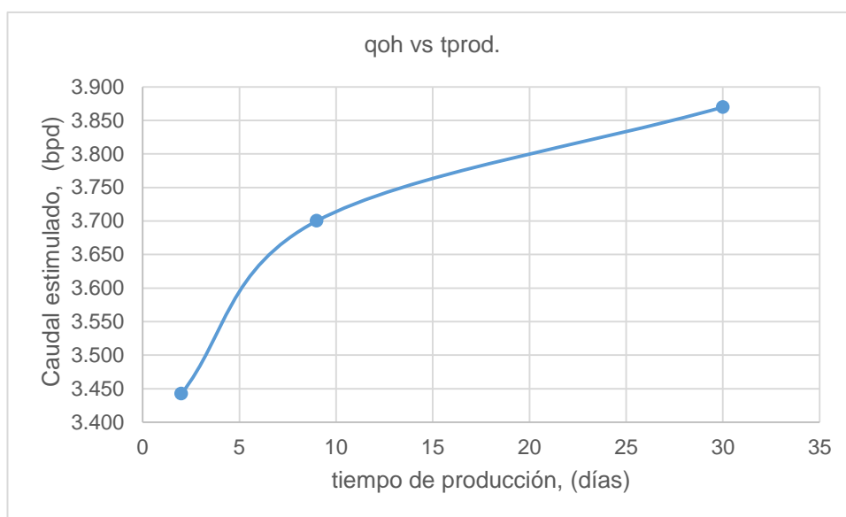
Figura 21: Caudal de petróleo producido vs Tiempo de producción en una tubería con aislante
