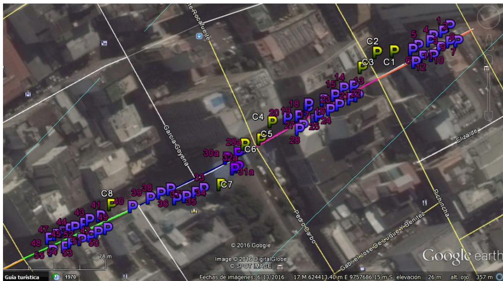
Figura 4.10: Ubicación de nodos sensores y repetidores en la Av. 9 de Octubre
