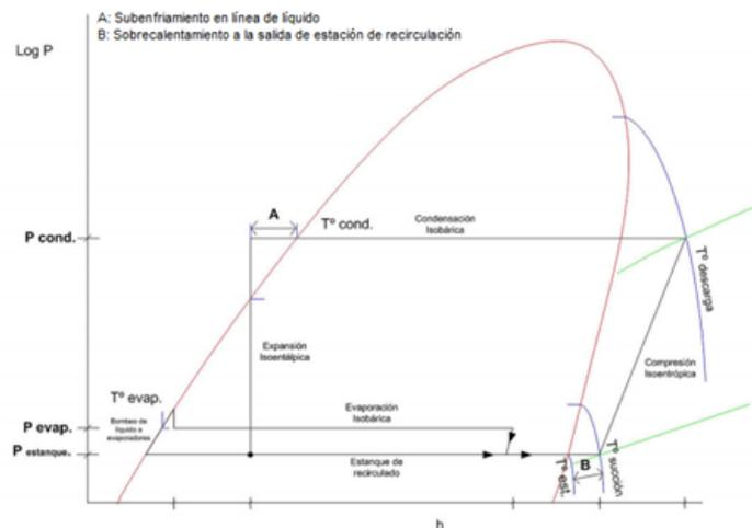
**Figura 6. Diagrama P-H para ciclo de refrigeración
