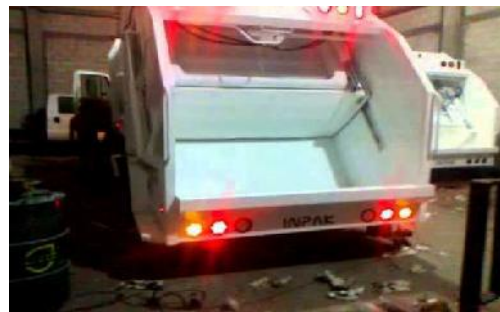
Figura. 2 Fotografía de una tolva, deslizador y cuchilla de un camión recolector de basura.
