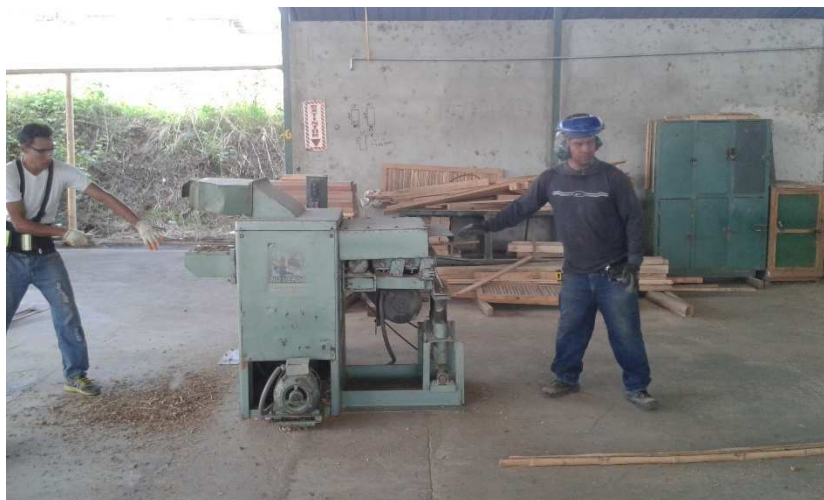
Ilustración 7 Máquina cortadora con sierras múltiples marca: Hermance Machine
