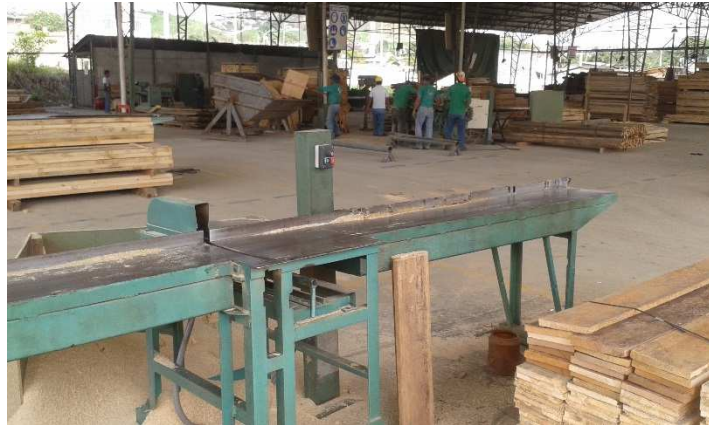
Ilustración 6 Máquina Cortadora con 1 sierra circular marca: OITB
