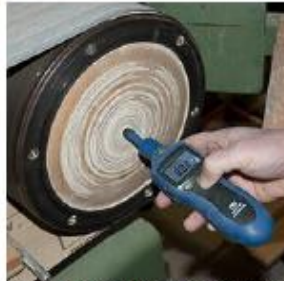
El tacómetro por láser en una medición con contacto
