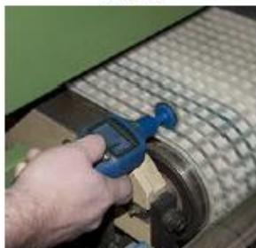
El tacómetro por láser en una medición con contacto en una cinta transportadora.
