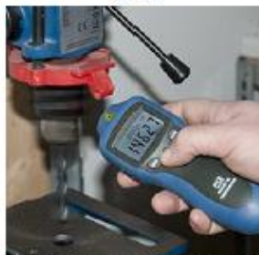
El tacómetro por láser en una medición sin contacto en una taladradora.
