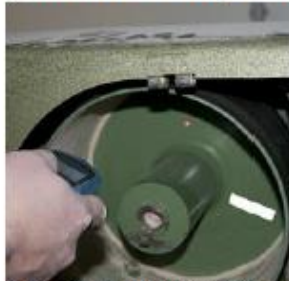
El tacómetro por láser en una medición sin contacto
