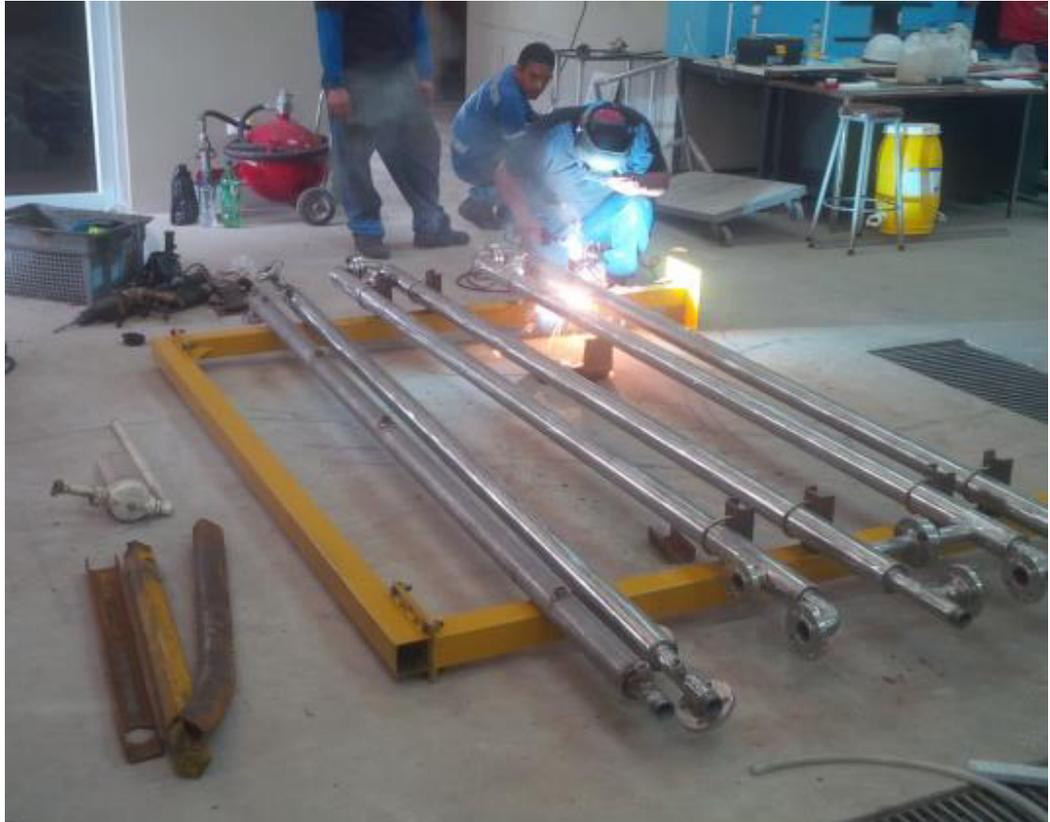
*Gráfico 10. Instalación de tubos en estructura.*
