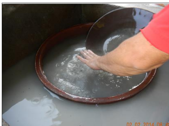
Gráfico 4.17: Concentración Gravimétrica en Platón
