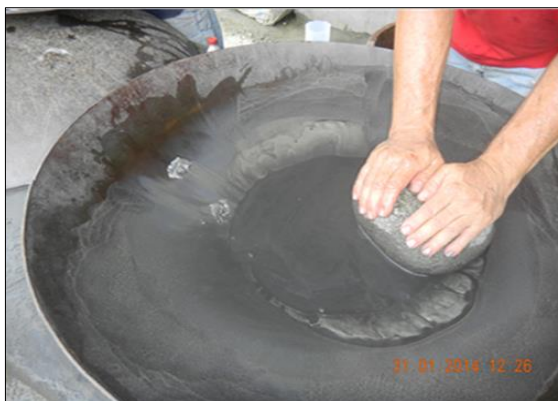
Gráfico 4.18: Platón de Liquidar con Oro en forma de Amalgama
