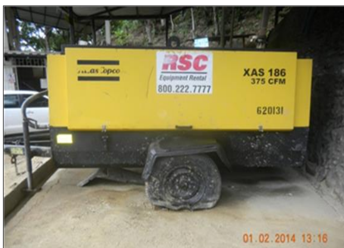
Gráfico 4.7: Compresor Atlas Copco 375 CFM
