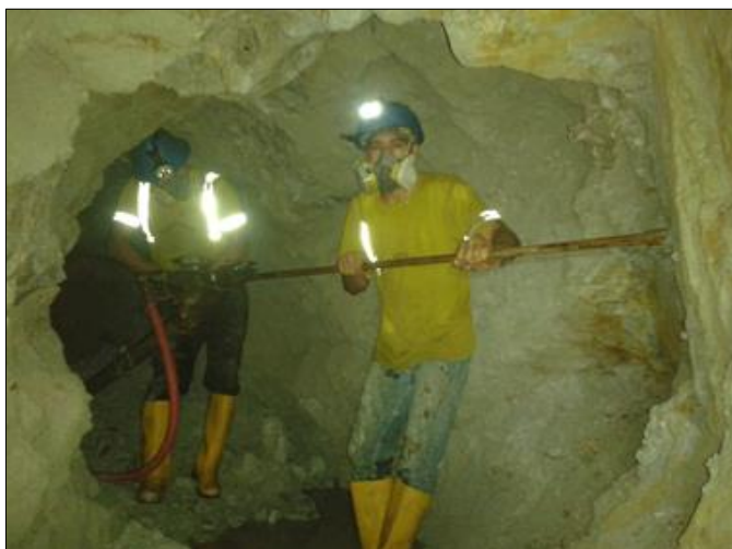
Gráfico 4.9: Máquina de barrenar Atlas Copco YT27
