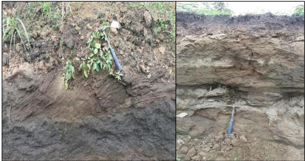
**Descripción:** Afloramiento de areniscas con estratificación cruzada alternadas de sedimentos limosos.
