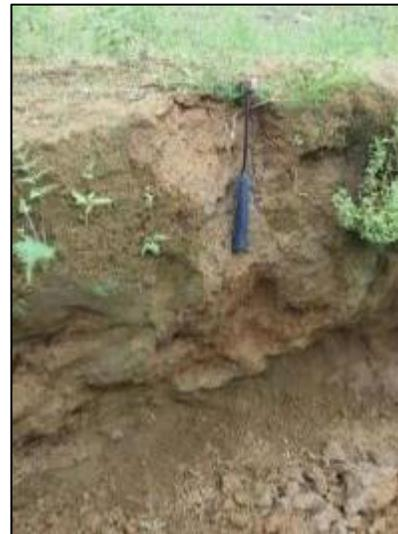
**Descripción:** Afloramiento compuesto por sedimentos limosos.
