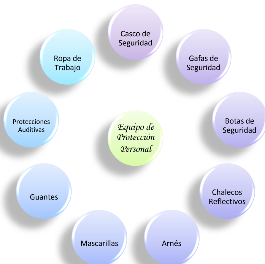
Figura 2.2.3.4. Principales Equipos de Protección Personal
