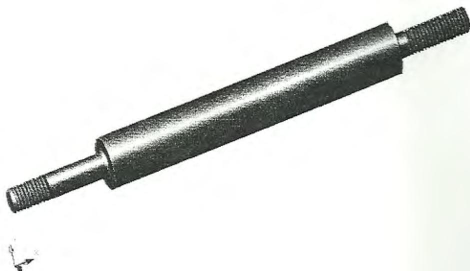
FIG.3.24 DISEÑO DE FORMA DE LOS TEMPLADORES DEL CILINDRO DEL PALTO EYECTOR.
