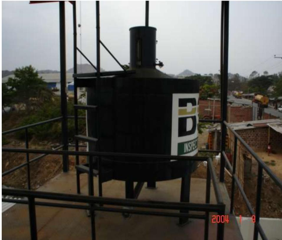
**FIGURA 1.2 PATRON VOLUMÉTRICO DE 500 GL.**
