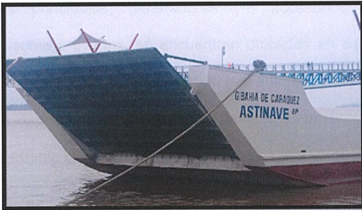
Figura 0.5 Compuerta de la Gabarra Bahía de Caráquez
