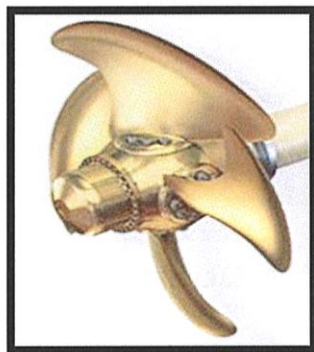
Figura 0.8 Hélice de Paso Variable
