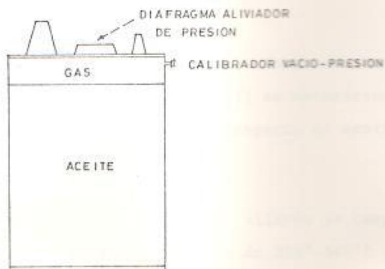
FIG. 6.2. TANQUE DEL TIPO SELLADO. EL ESPACIO DEL TANQUE ARRIBA DEL ACEITE ES LLENADO CON GAS A BAJA PRESION. (3)
