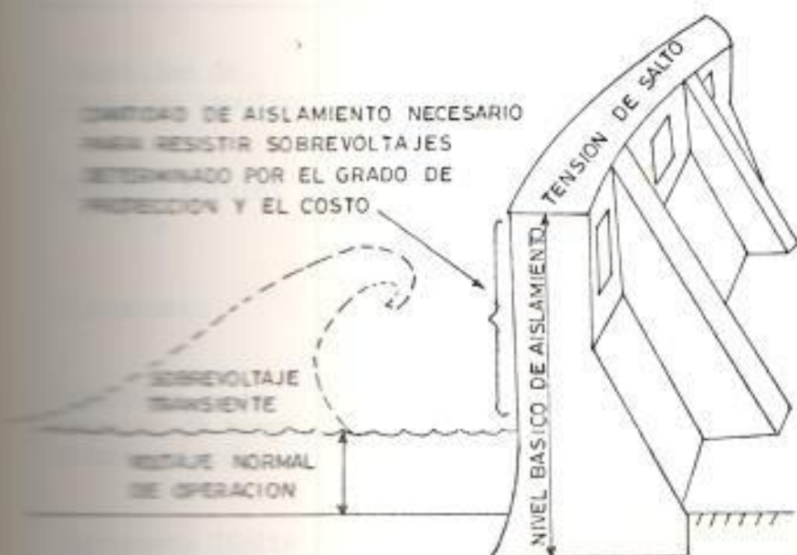
FIG. 2.4. ANALOGIA ENTRE UN SISTEMA DE DETENCION DE AGUA Y EL SISTEMA DE AISLAMIENTO. (3)
