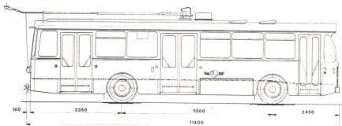
FIGURA No. 3.5(A) MEDIDAS EXTERNAS DE UN TROLEBUS MODELO SENCILLO.
