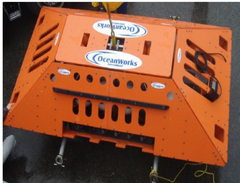
Figura 3.17: Nodo del Sistema de Cables Submarinos Peruano [36]
