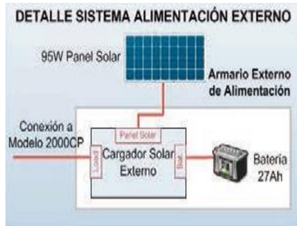
Figura 3.10: Sistema de energía solar básico [34]
