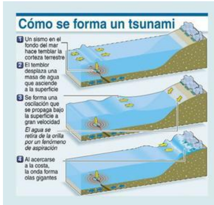
Figura 2.2: Esquema de cómo se forma un tsunami [9]
