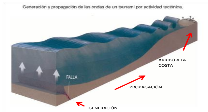
Figura 2.4: Generación, propagación y llegada a la costa de un tsunami por actividad tectónica [13]
