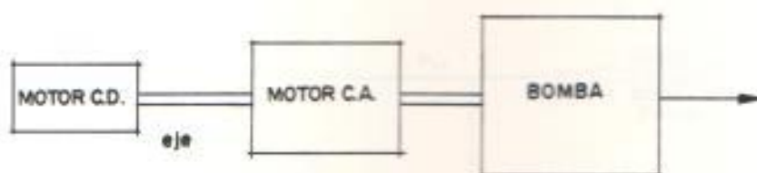
Figura 7.1. Motor de corriente directa acoplada al mismo eje
