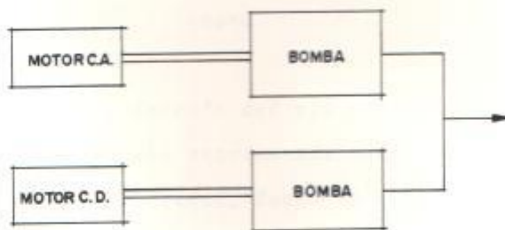
Figura 7.2. Sistema de doble bomba
