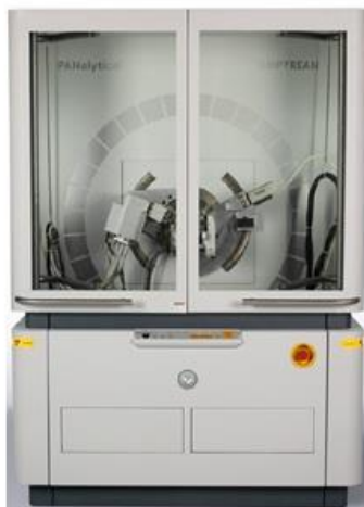
Figura 6: Equipo de Rayos X Panalytical Empyrean
