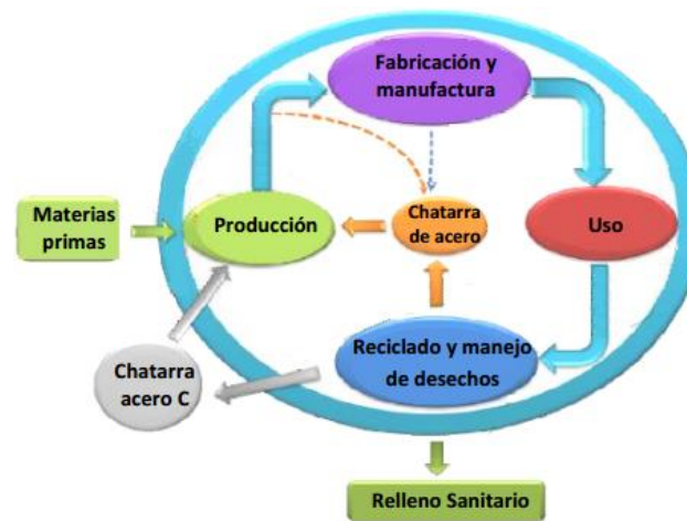
Figura 3: Esquema general de manufactura del Acero Inoxidable
