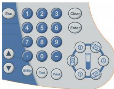
Figura 16: teclado de un Espectrofotómetro Genesys 10s UV Vis
