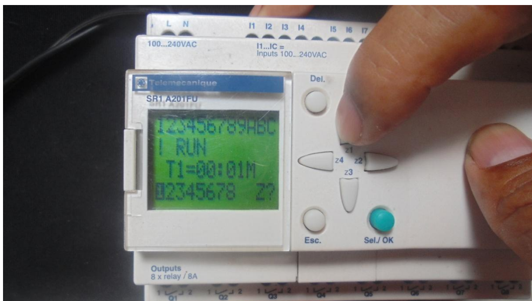
Foto 6: simulando aproximación de vehículo, pulsando Z1 acciona salida Q1, subir puerta.
