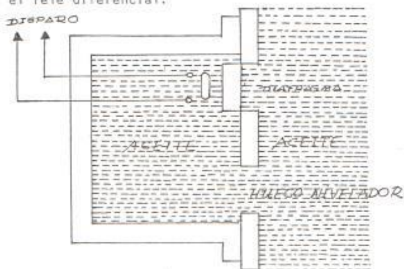
FIGURA N o 3.3.- PRINCIPIO DEL RELE DE PRESION SUBITA
