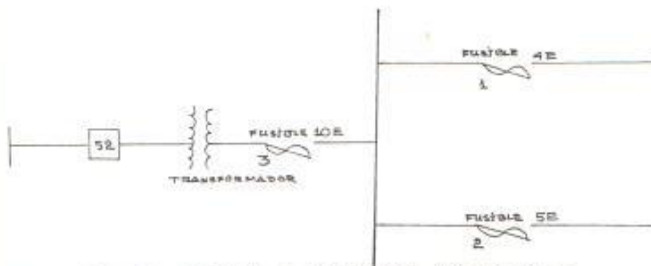
FIGURA N° 3.16.- ESQUEMA DE PROTECCION CON FUSIBLES
