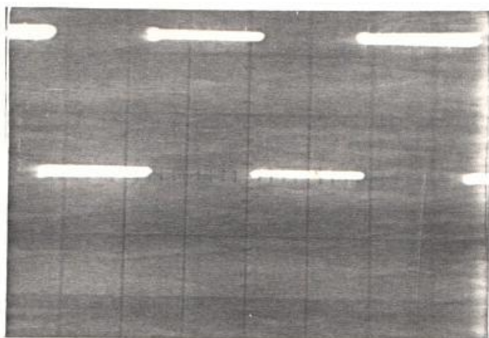
Fig.6.9 Señal de salida del modulador PWM, para 0^\circ (2 V/div, 5 ms/div)
