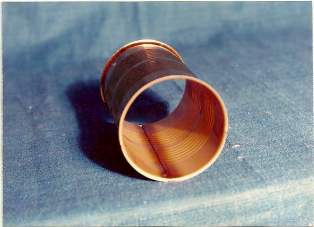
FIG. # 9.- Barnizado interior quemado
