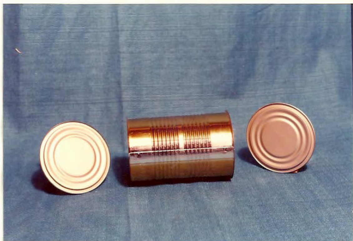
FIG. # 1.- Envase sanitario de tres piezas ( cuerpo, fondo y tapa) con costura lateral.
