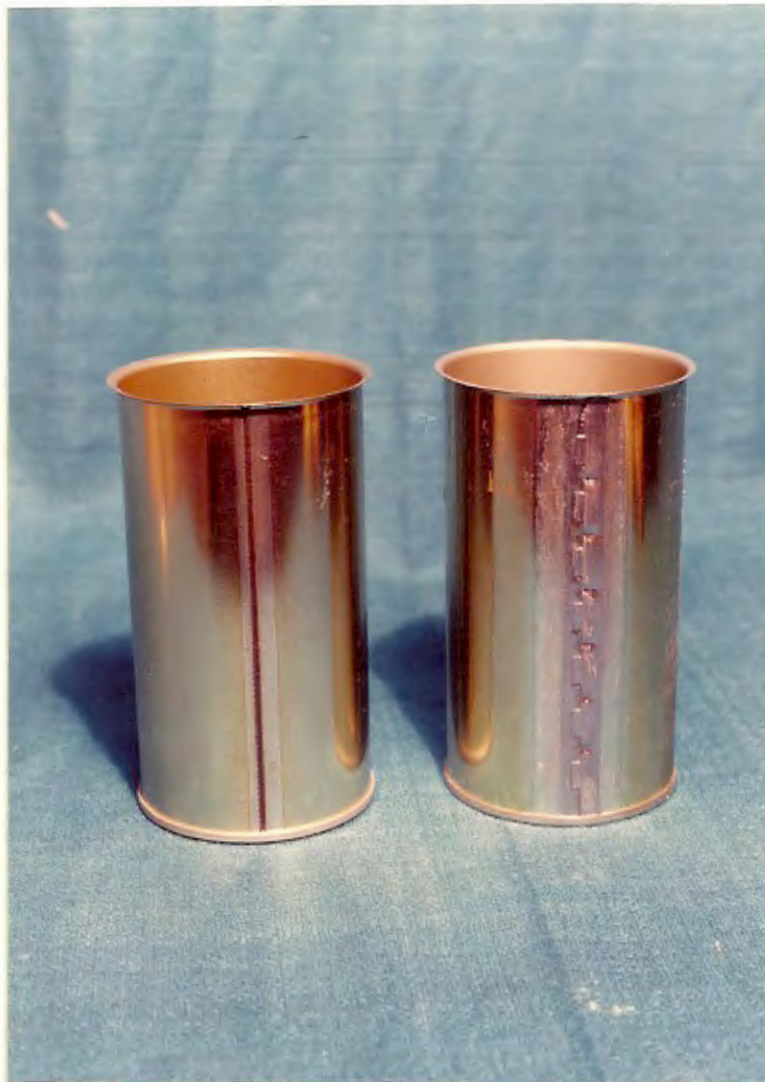
FIG. # 11.- Envase con soldadura Soudronic (izq.) y envase con soldadura de proceso anterior (der.).
