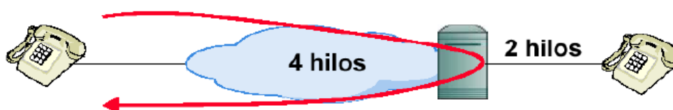
Figura 12. Eco causado por reflexiones en el circuito
