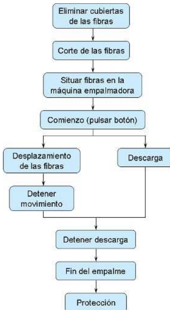
Fig. 1-12.- Procedimiento de empalme de fibras por fusión.
