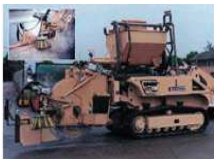
Fig. 4.13 Maquina para microzanjado
