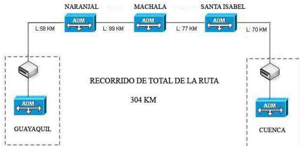
Fig.3.11 Esquema en detalle del recorrido de la fibra óptica GYE-CUE
