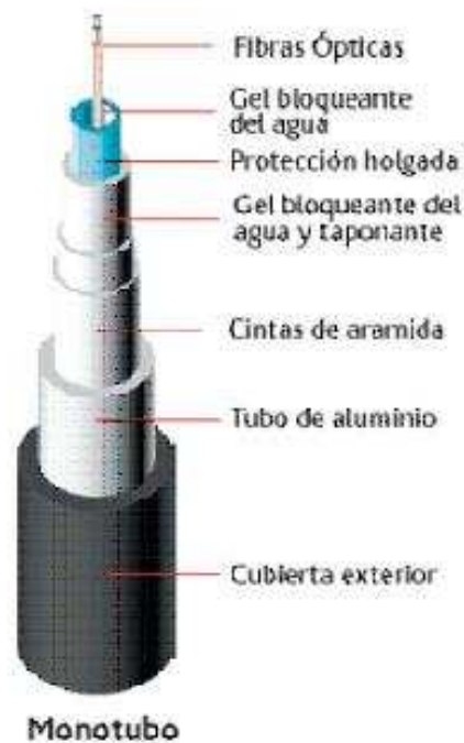
Fig. 4.10.- Morfología del cable de fibra utilizada
