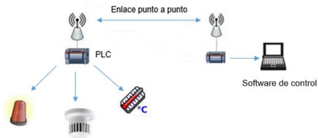
Figura 2.1: Esquema de telecontrol con enlace dedicado
