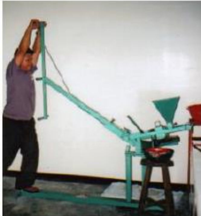
Apéndice A.2. Prensa tipo Ram Bielenberg
