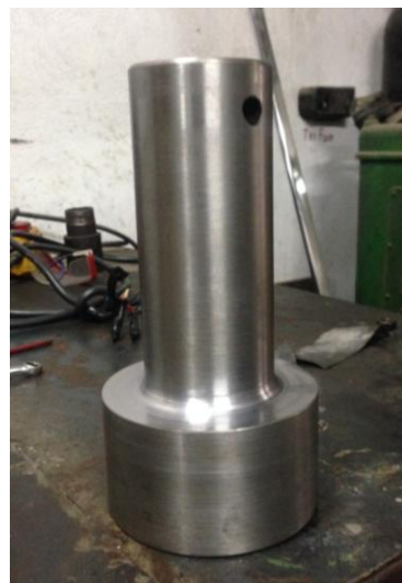
Figura 3.8 Condición final del pistón Agosto 2017
