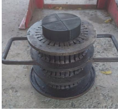
Figura 2.18. Verificación de dimensión de la cabeza del pistón en la jaula de ardilla
