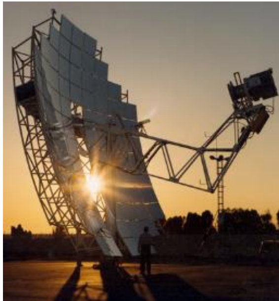
Figura 2.6 Disco parabólico de espejos planos
