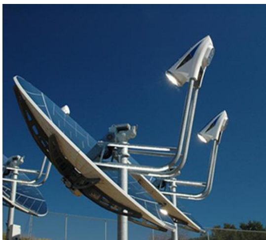
Figura 2.5 Disco parabólico de membranas de metal
