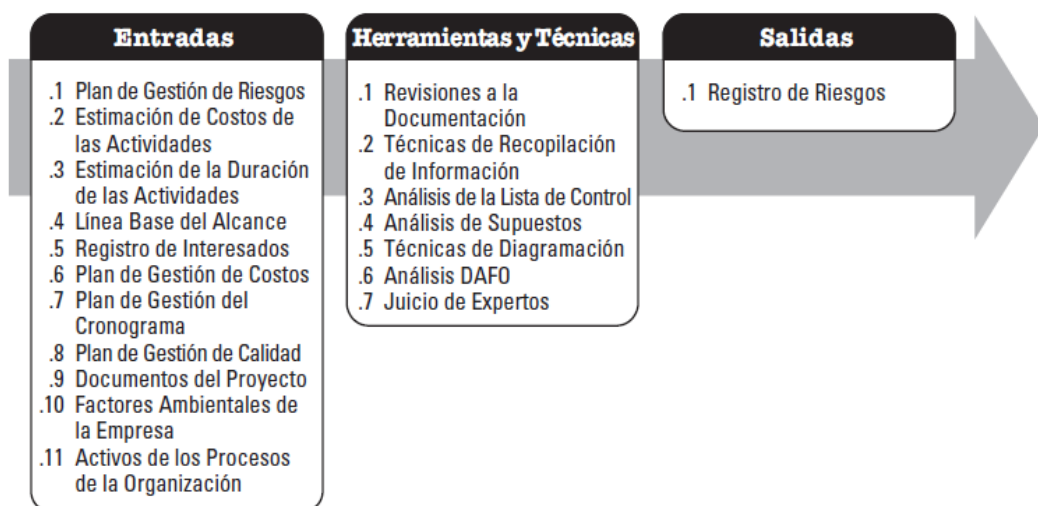
Figura 2. 1 Identificar los Riesgos: Entradas, Herramientas y Técnicas, y Salidas –
