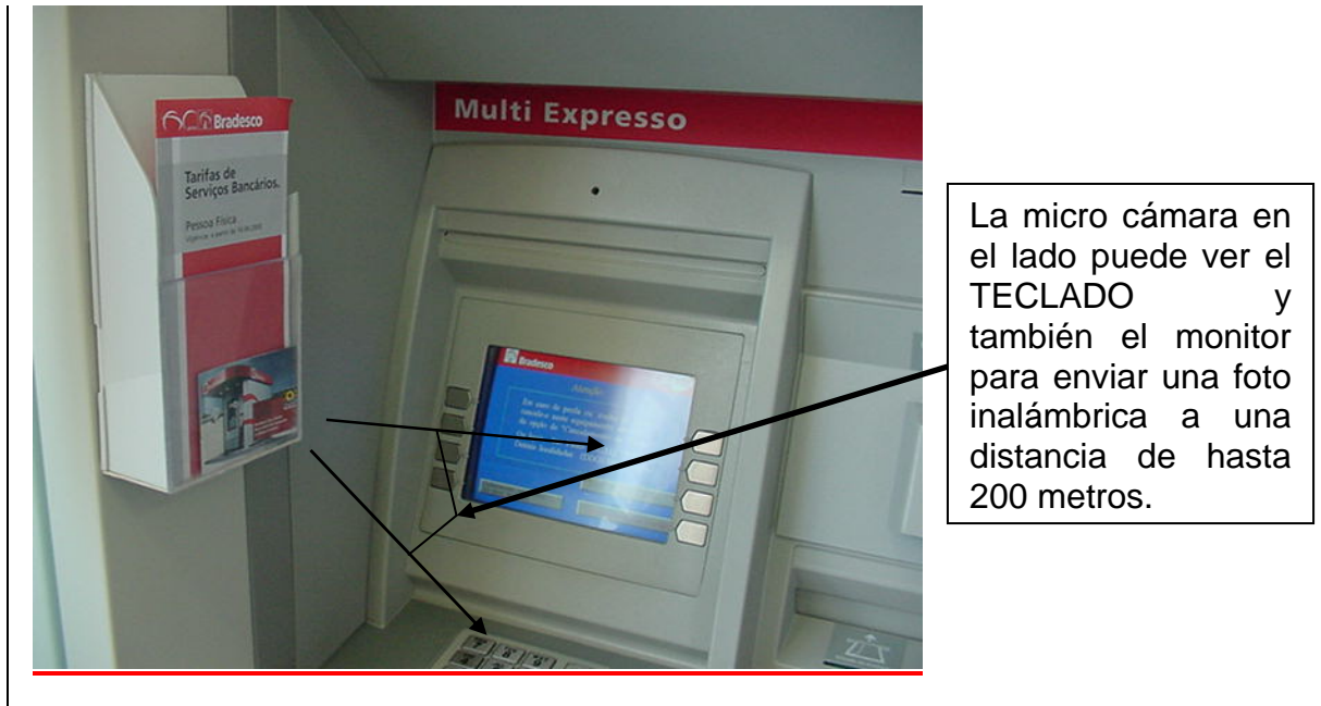
Figura 3.5 La micro Cámara frente Monitor del Cajero
