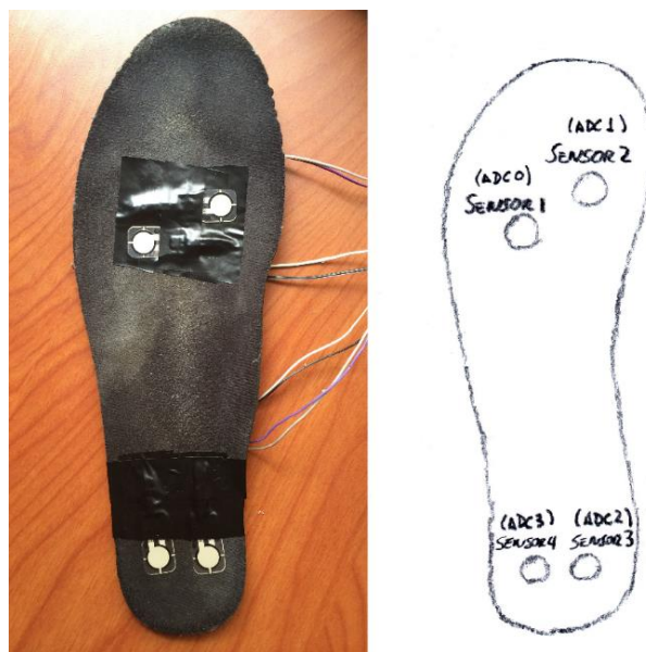
Figura 2.17 Ubicación de sensores en la plantilla del dispositivo.
