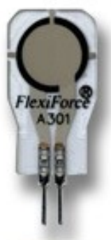
Figura 2.5 Sensor de fuerza FlexiForce® A-301.
