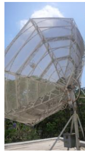
Figura 2.3 Antena Tipo Grillada.
