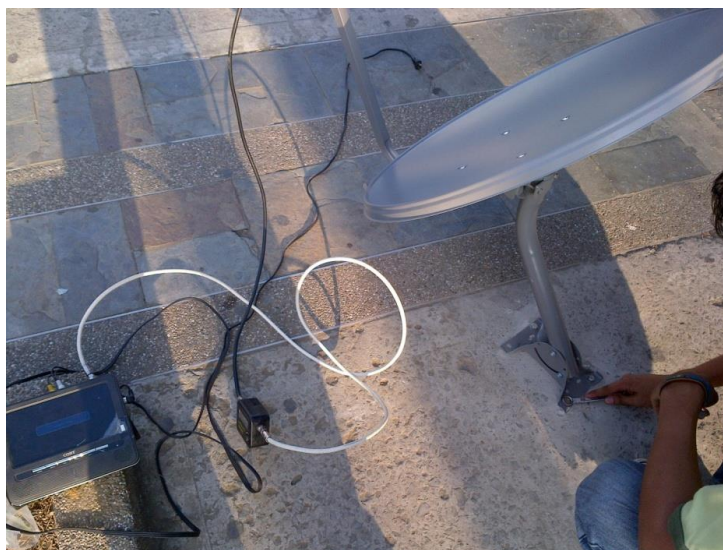
Figura A.10 Búsqueda de la Calidad con Equipos Profesionales de Medición de Potencia.
