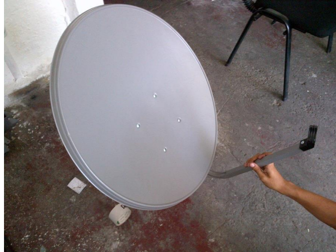
Figura A.7 Ensamblaje Completo de la Antena.
