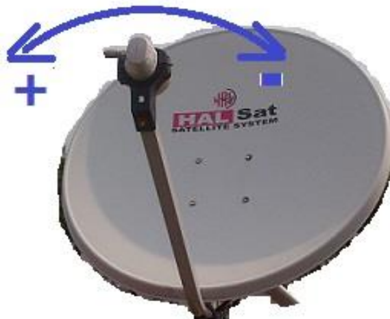
Figura A.16 Giro Correcto para la Polarización del LNB (skew)
